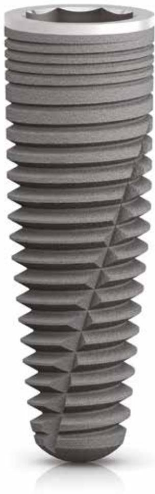
Il filetto a profilo conico ha un passo di 0.6 mm e profondità di 0.4 mm, per fornire **più superficie di contatto in caso di osso più spongioso.**
