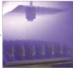
Réacteur au plasma en fonction lors d'un processus de décontamination de la surface des implants.
