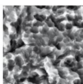
Il **corpo ZirTi** è sabbiato con ossido di zirconio e mordenzato con acidi minerali, tecniche che conferiscono alla superficie la caratteristica micromorfologica in grado di **aumentare notevolmente la superficie di contatto osso-impianto** e garantire un'ottima stabilità primaria.
