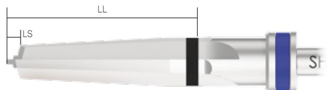
**Nota bene:** Le frese realizzano sempre un foro più lungo dell'impianto che si desidera inserire. Il sovradimensionamento (LS) è pari all'altezza della punta della fresa che si sta utilizzando (si veda immagine sopra e dimensioni nella tabella della pagina accanto).
