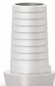
Apposite cannule da inserire sul corpo conico delle T-Connect facilitano la modellazione del wax up nel rispetto dei volumi: l'altezza totale di 12 mm aiuta a preservare il foro vite da accidentali ostruzioni.
