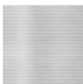
La **superficie macchinata** rende meno facile l'adesione e l'accumulo di placca e per questo costituisce un environment meno favorevole alla proliferazione batterica, rispetto a superfici ad alto grado di rugosità. In caso di ambienti orali particolarmente predisposti a patologie dei tessuti perimplantari, **la pulizia della superficie macchinata risulta più semplice ed efficace con tutte le metodiche comunemente utilizzate.**
